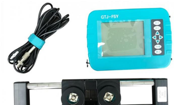
El probador de profundidad IWIN-FSY Crack se basa en el principio de difracción acústica para medir la profundidad de grieta de la superficie del concreto.
