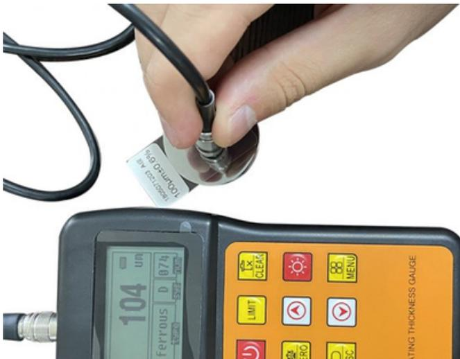
Inducción magnética y corrientes de Foucault, método de medición continua,
