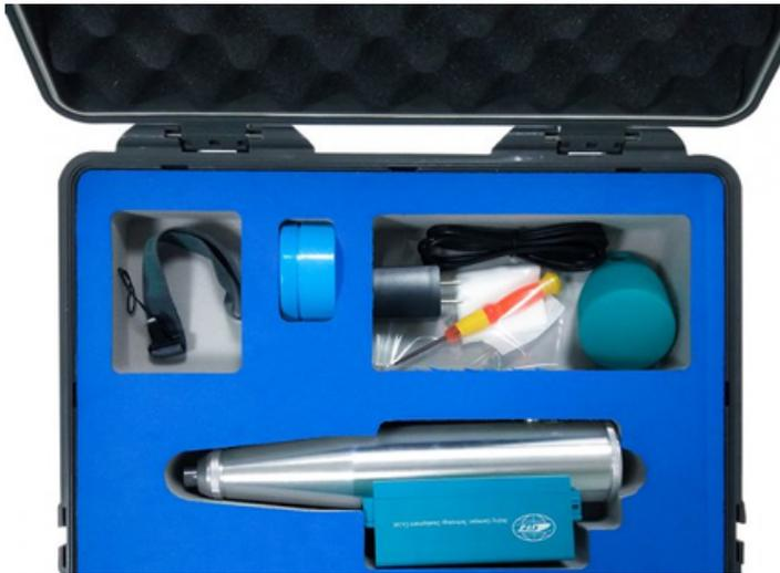
Instrumento de prueba y evaluación no destructivo para la resistencia a la compresión de hormigón endurecido en estructuras de edificios.
