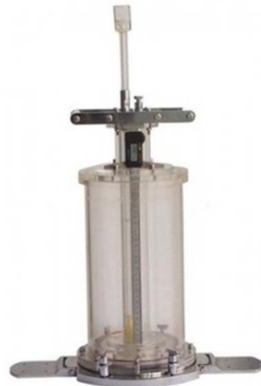
instrumento de prueba para medir la densidad del suelo. Es adecuado para medir in situ la densidad del suelo con un tamaño máximo de partícula inferior a 200 mm.
