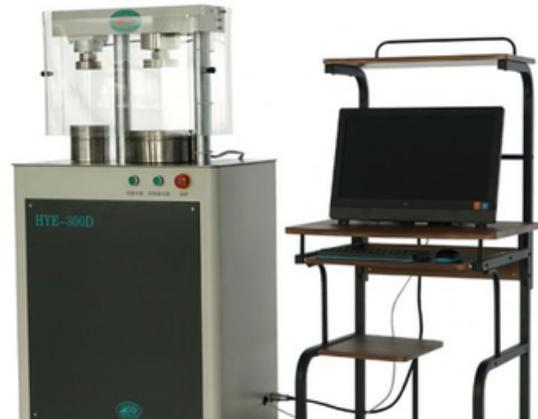
La máquina de prueba prueba las propiedades mecánicas del cemento, mortero, ladrillo, hormigón y otros materiales de construcción con tecnología de control de aceleración y desaceleración del servomotor, mostrando el valor de carga, la velocidad de carga y la curva de carga.
