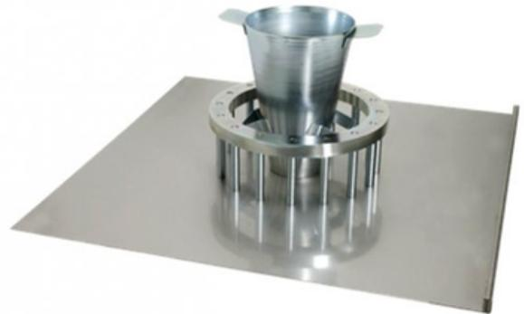
La prueba del anillo en J se puede utilizar para determinar la capacidad de paso del concreto autoconsolidante.
