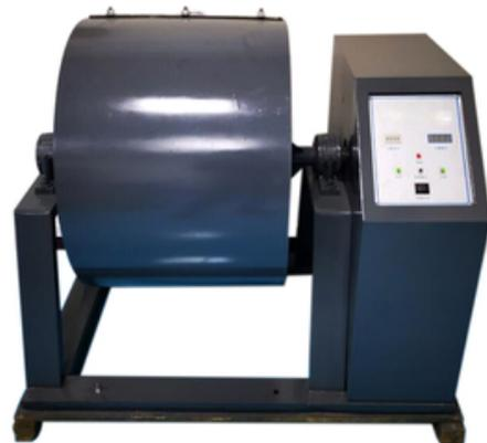
Se utiliza para determinar la resistencia de los agregados a la fragmentación.
