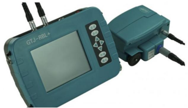
El localizador de barras de refuerzo es un instrumento portátil de ensayos no destructivos, que se puede utilizar para la detección de la calidad de construcción de estructuras de hormigón armado.
