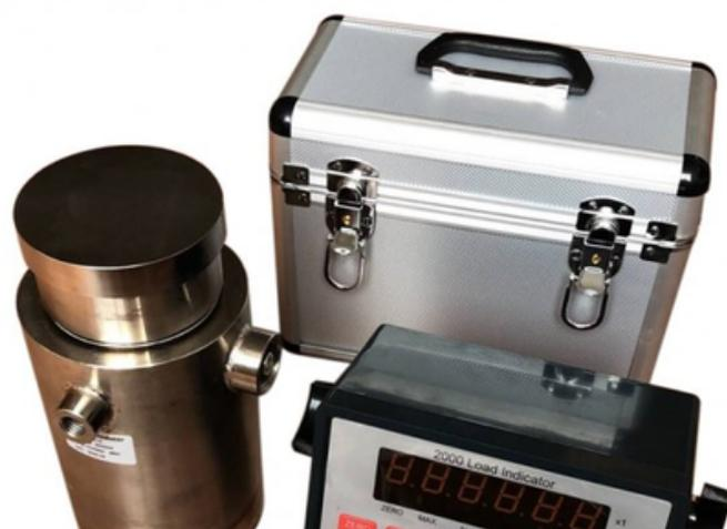
La calibración de fuerza de la máquina de prueba de compresión y flexión se puede realizar utilizando una célula de carga conectada a un probador digital.
