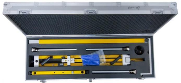
Se utiliza para medir el valor de asentamiento de Subrasante bajo carga estática, a fin de evaluar la capacidad de carga y la deformación de la subrasante.
