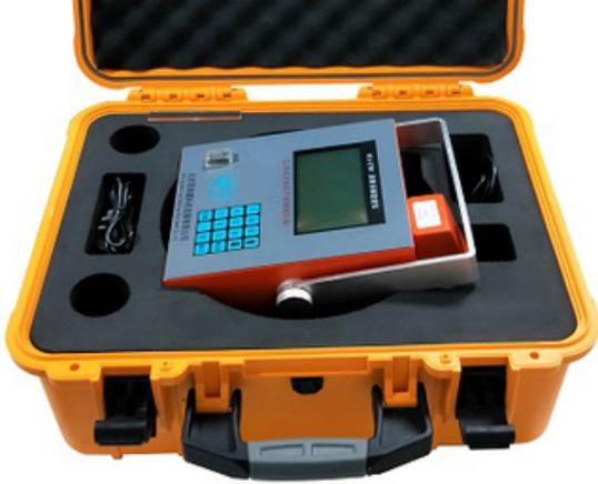
El medidor de densidad de asfalto no nuclear es directamente proporcional a la constante dieléctrica del material que se está probando.
