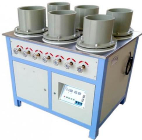
Se utiliza para probar la permeabilidad del concreto, también se puede usar para probar otros materiales de construcción.
