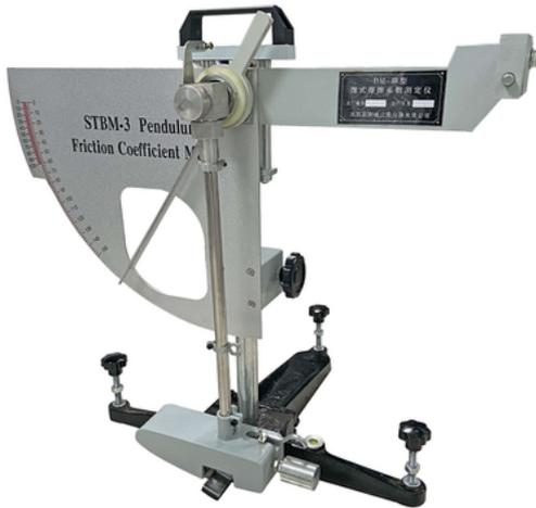
El probador de coeficiente de fricción de péndulo (denominado instrumento de péndulo) es un instrumento para medir el coeficiente de fricción de la superficie de la carretera, la pista del aeropuerto, la pintura de marcado.
