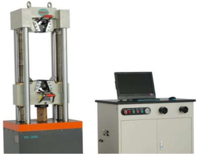
La pantalla de la computadora muestra la curva de carga, el valor de fuerza, la velocidad de carga, el desplazamiento, etc. Datos, imprimir resultados de datos. Es un equipo indispensable para unidades de investigación científica, plantas de fabricación metalúrgica y mecánica, estaciones de inspección de calidad y colegios y universidades.
