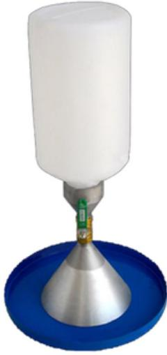
La prueba consiste en cavar un agujero en el suelo y luego recolectar, secar y pesar el suelo muestreado. Luego, el agujero se llena con arena seca del contenedor de cono y se registra el volumen de arena.
