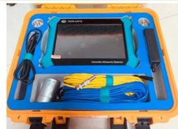
Detector ultrasónico no metálico, resistencia a la compresión del concreto estructural, profundidad de grieta, ancho de grieta y detección de defectos; Método de transmisión ultrasónica para detectar la integridad de la pila y la pared continua.
