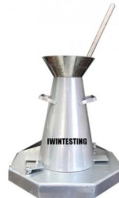
Este método de prueba cubre la evaluación de la deformabilidad del concreto. autocompactante recién mezclado.
