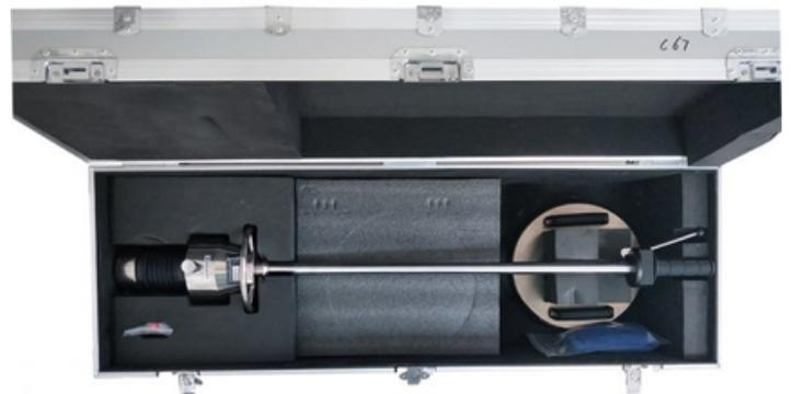
Se utiliza para evaluar el valor de deflexión de la subrasante en capas bajo carga dinámica, a fin de evaluar la capacidad de carga y la deformación de la subrasante.
