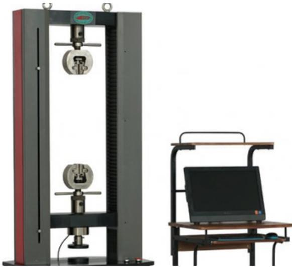
Esta máquina de prueba es adecuada para las pruebas de propiedades mecánicas y la investigación de metal, caucho, plástico y otros materiales.
