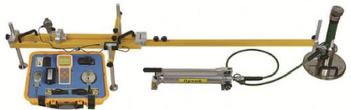
se puede utilizar para probar el coeficiente de cimentación del suelo grueso y fino y el lecho de carretera compactado, el curso base, etc.
