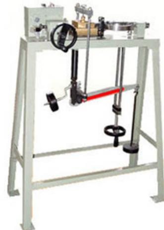
En muchos problemas de ingeniería, como el diseño de cimientos, muros de contención, puentes de losas, tuberías, tablestacas, se requiere el valor del ángulo de fricción interna y la cohesión del suelo involucrado para el diseño. La prueba de cizallamiento directo se utiliza para predecir estos parámetros rápidamente.
