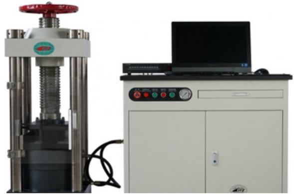
La serie de máquinas de prueba son accionadas hidráulicamente, roca, mortero, ladrillo, hormigón y otros materiales de construcción para probar las propiedades mecánicas de la compresión, mostrando el valor de la fuerza de carga, la velocidad de carga y la curva de carga.
