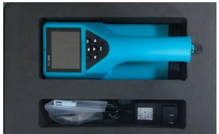
Instrumento portátil de pruebas no destructivas, que se puede utilizar para probar la calidad de la construcción de estructuras de concreto armado.
