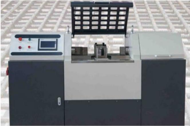
Un host. Sistema de control PLC Siemens. El núcleo de flexión está equipado de acuerdo con las necesidades reales.
