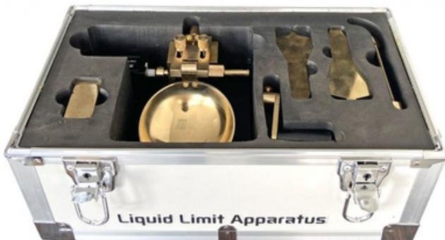
El límite de líquido es el contenido de agua en el que el suelo cambia de un estado líquido a un estado plástico, definido como un punto donde dos mitades de una muestra de suelo fluyen juntas cuando se agitan 25 veces de una manera específica utilizando una máquina de límite de líquido.
