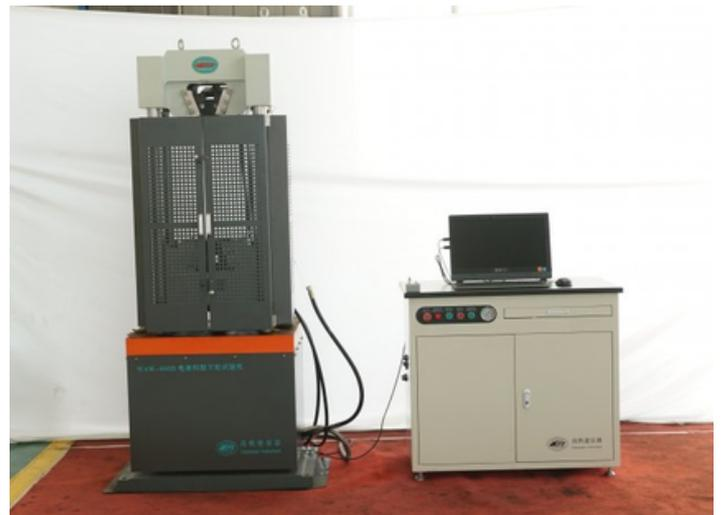
La serie de máquinas de prueba se cargan hidráulicamente. La tecnología de servocontrol electrohidráulico se utiliza para probar la tracción, compresión, flexión y cizallamiento de materiales metálicos y no metálicos.
