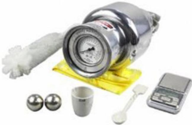
Un método de carburo de calcio para la determinación rápida de la humedad.
