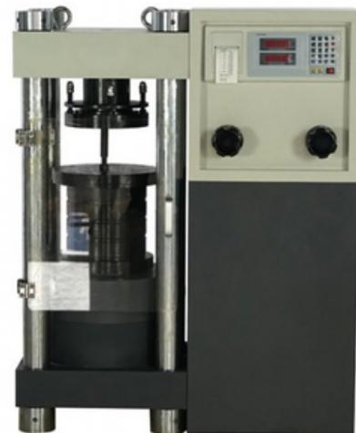
La tecnología de control manual se utiliza para probar las propiedades mecánicas de rocas, morteros, ladrillos, hormigón y otros materiales de construcción.
