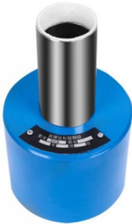
El yunque de acero de calibración es el equipo de soporte para la calibración del martillo de prueba de concreto, que se divide en tipo ligero, tipo ordinario, tipo especial de alta resistencia, etc.
