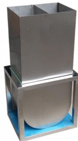
Se utilizó para probar la autocompactabilidad (fluidez confinada) del concreto autocompactante recién mezclado.
