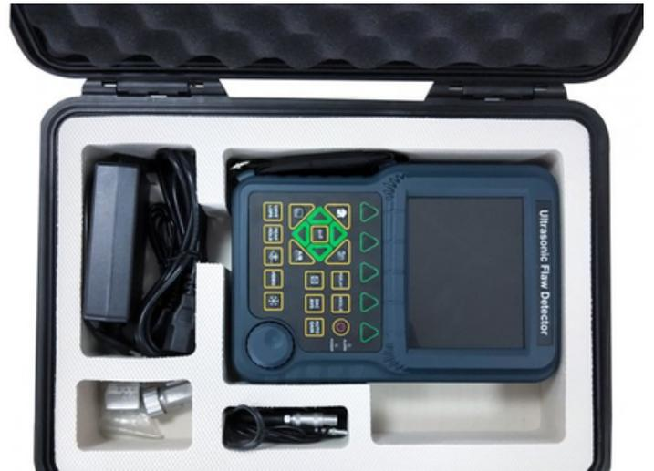
Es un instrumento de precisión profesional necesario para la detección de defectos, control de calidad, monitoreo de seguridad en servicio y evaluación de la vida útil en ferrocarriles, construcción naval, metalurgia, industria química, petróleo y otras industrias.
