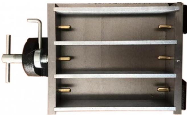
Se utiliza para determinar el efecto de los agregados en la contracción por secado del hormigón.
