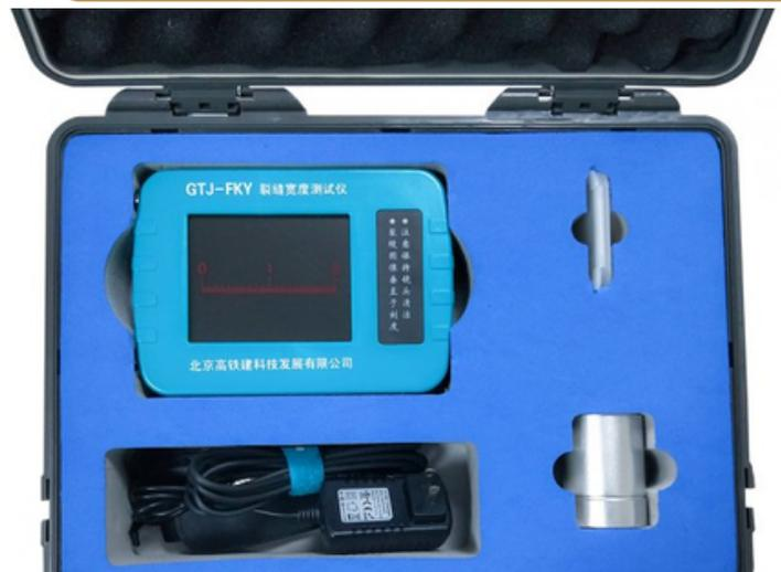
El medidor de ancho de grieta IWIN-FKY se utiliza para medir el ancho de grieta en edificios de concreto como casas, carreteras y puentes.
